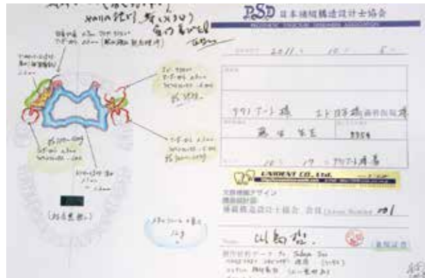
図30 本ケースの数値化された「構造設計図」。使用材料や器材も表記し、かつ「品質保証書」も兼ねている。本ケースの製作担当者（伊藤貴也氏）名も記入している。
