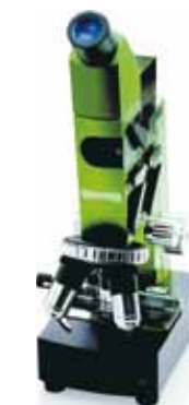
図5 蛍光顕微鏡 チェアサイドにおける蛍光染色の観察にはポータブル蛍光顕微鏡(CyScope®, パルテックジャパン)が便利である。
