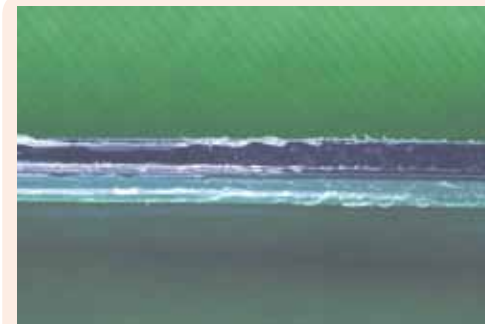
図6 エルコロック プロ(3.00mm)の断面図。ソフト側(図の下側・熱可塑性ポリウレタン)が歯側にくる。
