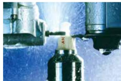
図2 ミリング法。歯科用CAD/CAMでは最も普及している方法であるが、バーの形状により加工精度に限界がある。
