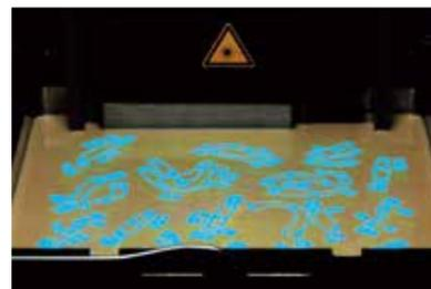
図3a, b 積層造形法は、CADデータを薄くスライスしたデータに変換し、1層ずつ積層しながら目標物を製作することで、一般工業界で「迅速に(Rapid)」「試作(prototyping)」することを目的とした三次元造形技術から応用された方法である。
