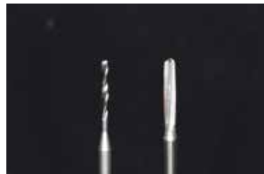
図5-9 外形ラインに沿ったトリミングには、専用の細いカーバイドバーを用いる。
