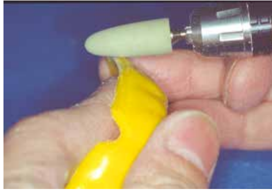
図5-5 研磨熱でシート材の温度を上昇させない方法で研磨する。シリコンポイントは発熱するので、使用は避ける。
