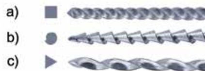
図 12-13 手用ファイルの断面形態と刃部形態 a) Kファイル、b) Hファイル、c) リーマー
