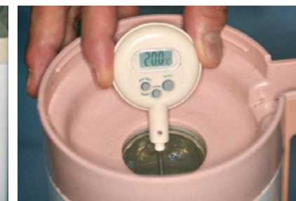
図 3-6 水の温度管理 硬化時間のばらつきを解消するため、水は常に20℃のものを用意しておく。
